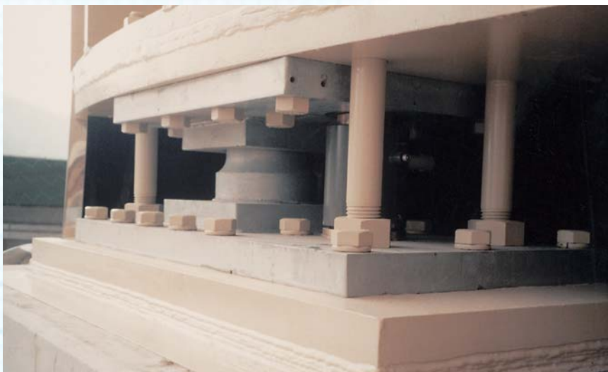
100tロードセル水平力90t用振れ止金具
